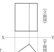
上の図の三角柱の投影図は、右の図のように表されます。
