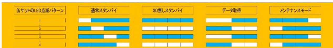
図 18：今回の缶サットにおける mbed 内蔵 LED のモード対応表
