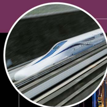
山梨リニア実験線（山梨県都留市） 超伝導電磁石を使用して車体を浮上させて走行するリニアモーターカー。
