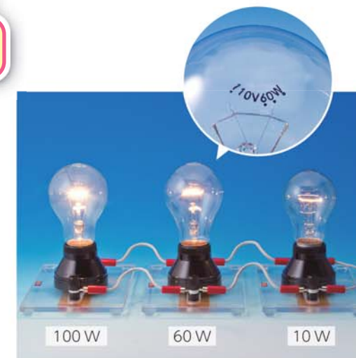
図22 電球に示された電力と明るさ
