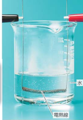
図 24 電熱線の発熱による水温の上昇
