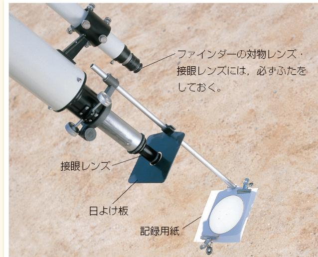
太陽は非常に光が強く、熱エネルギーも強いため、肉眼で直接太陽を見ると網膜にやけどを負います。黒い下敷きを用いて減光しても赤外線は下敷きを通り抜けるため、同様です。虫眼鏡で光を集めると紙が燃えるように、直径が6cmの望遠鏡は、肉眼の約100倍の光を集めます。ファインダーの対物レンズにも必ず蓋をするのを忘れないようにしましょう。また、投影版を使った観察でも、接眼部から太陽をのぞこうとする生徒がいるので注意しましょう。
